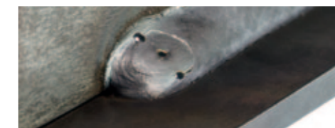
Mit Endkraterfüllung - perfektes Nahtende
